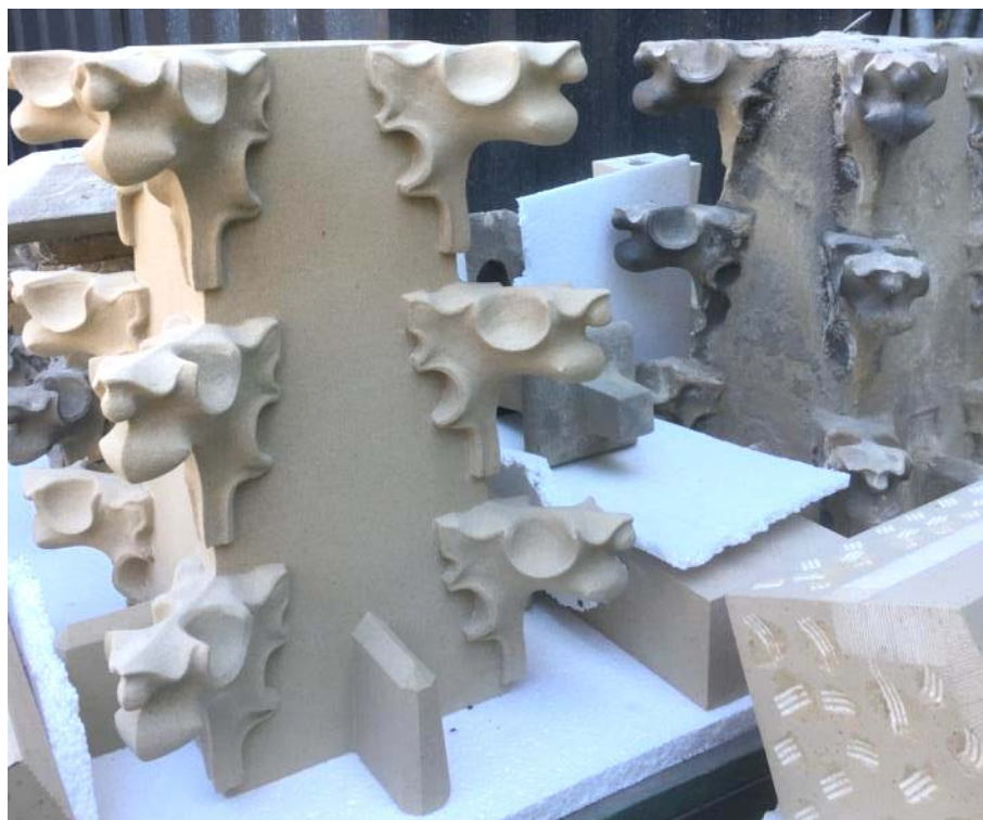
Kopiëren. Vernieuwen van pinakels voor de Sint Jan in Den Bosch van Udelfanger zandsteen. Op de achtergrond een pinakel van 1870, op de voorgrond een pinakel gemaakt in 2020. Het materiaal is in beide gevallen hetzelfde. De oude pinakel is volledig handmatig geproduceerd, de nieuwe in een combinatie van machines en handgereedschappen, wat in bewerkingssporen vrijwel hetzelfde resultaat oplevert. In dit geval spreken we dus van kopiëren.
